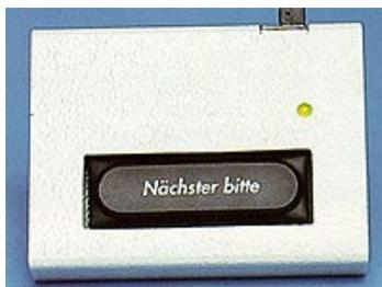
Um die Raumnummer einzustellen, halten Sie die "Nächster Bitte" Taste so lange gedrückt, bis die Raumnummer an der Anzeigetafel schnell blinkt (nach ca. 6 Sekunden) und lassen sie dann los.
