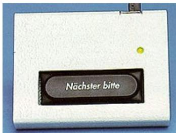
Um die Aufrufnummer einzustellen, halten Sie die "Nächster Bitte" Taste so lange gedrückt, bis die Aufrufnummer an der Anzeigetafel schnell blinkt (nach ca. 3 Sekunden) und lassen sie dann los.
