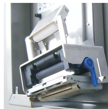
Verriegelungshebel in Stellung "auf" (Papier einfädeln)
