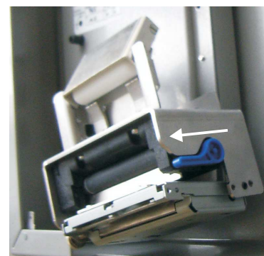
Verriegelungshebel in Stellung "zu" (Normalbetrieb)
